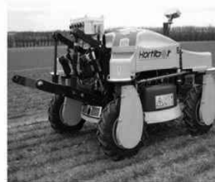
덴마크의 아르후스(Aarhus) 대학에서 2007년에 개발한 농업로봇(hortibot)이다. hortibot은 원예농사(horticulture)와 로봇(robot)이 합쳐진 이름이다. 알의 종류에 따라 여러 가지 로봇 손으로 교환해 가며 쉬지 않고 일한다.
